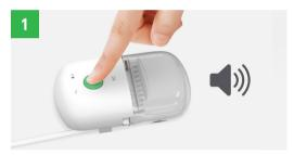
Keskeytä pumpun toiminta painamalla vihreää käynnistyspainiketta ja vapauta se kahden (2) sekunnin kuluttua. Pumppu antaa kaksi äänimerkkiä merkiksi siitä, että se on keskeytystilassa.
